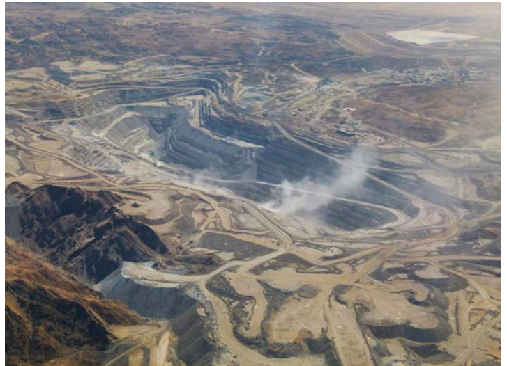
Abb. 12: Der „mining footprint“ von Rössing mit seinem Tagebau und seinen Abraumhalden umfasst 2400 Hektar. Die Staubwolke deutet auf eine Sprengung uranhaltigen Gesteins hin. – Luftbild: Rainer Glawion (2011)
