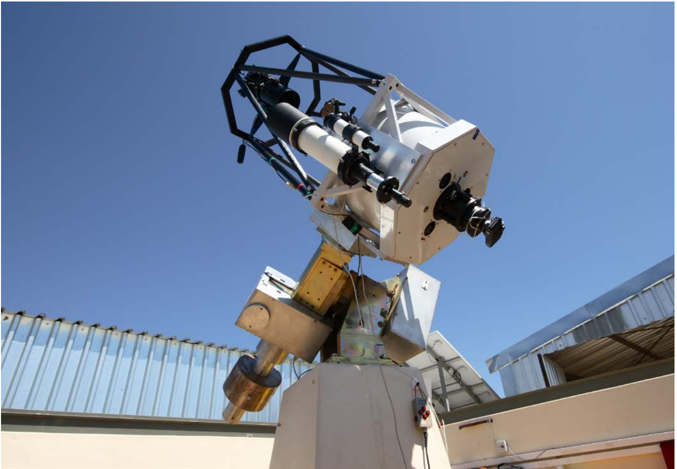
Abb. 1: Das 50-cm-Cassegrain-Teleskop auf der Liebscher Montierung
