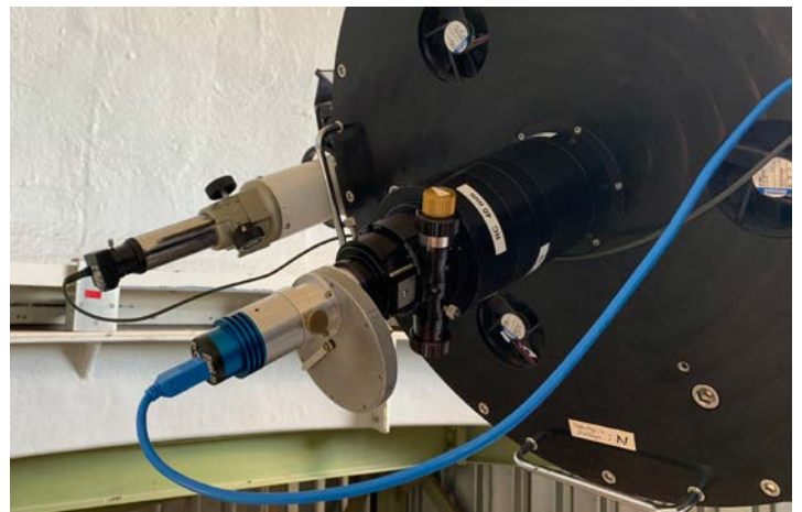
Abb. 1: Die Aufnahmekamera QHY 178 mit Filterrad am RC20. Darin integriert ist auch eine Barlow-2x-Linse. Dahinter sieht man das Sucherfernrohr, ebenfalls mit Kamera, die mit einem größeren Gesichtsfeld das Auffinden und Zentrieren der Objekte erheblich erleichtert
