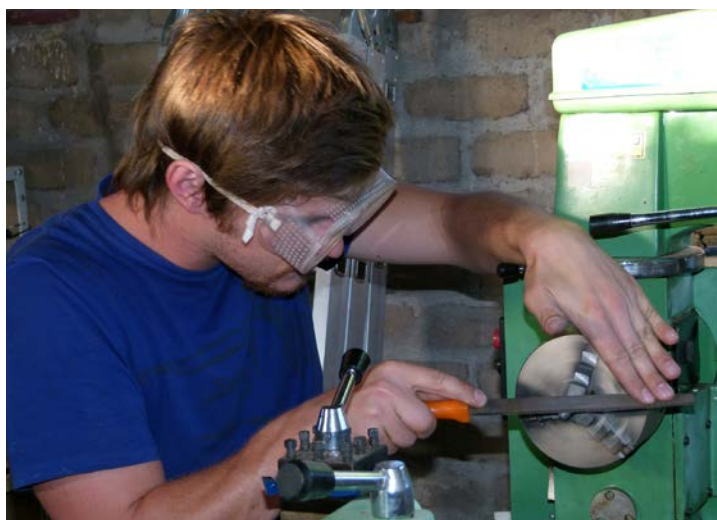
Abb. 5: Die inneren Planeten werden von Thomas Roßwog aus Schraubenköpfen gedreht
