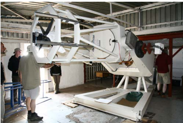
Abb. 4: Der 71-cm-Newton (Wolf-Peter-Hartmann-Teleskop) in der Parkposition
