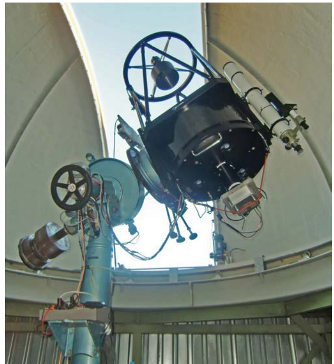
Abb.25: Alluna RC 20 auf Zeiss-Montierung
