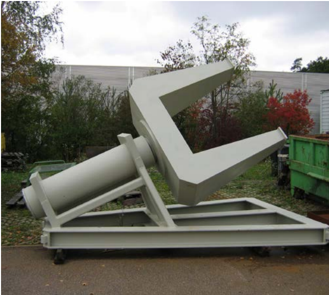
Abb. 1: Gabelmontierung mit Untergestell
