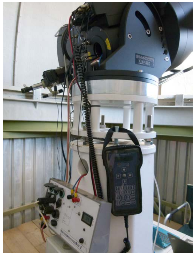
Abb.29: Säule mit Batterieanschlussbox und Montierung GM4000 von 10 Mikrometern mit Handsteuerbox
