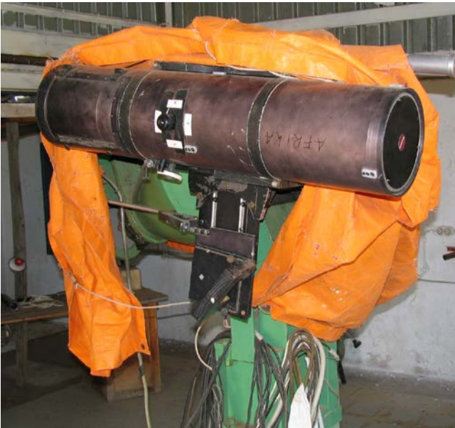
Das 7"-Questar-Teleskop, das auf dem Gamsberg für Seeing-Messungen in den 1970er Jahren eingesetzt wurde. – Foto: Rainer Glawion (2004)
