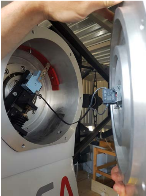
Alt-Achse mit mechanischer Bremse
